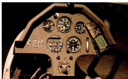
Ombord i cockpit er det avanserte instrumenter, blant annet GPS og radio, høydemåler, fartsmåler og måler for flyets stige- og synkehastighet. Foto: Tom E. Hole.
